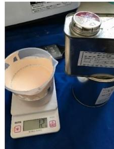
※パイロキープ、フォック、セラポリマー計量、特に硬化促進剤の計量は料理用精密計量器等をご使用下さい。(硬化促進剤の計量はメモリ付きスポイドも可能)
