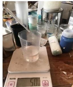
※パイロキープ、フォック、セラポリマー計量、特に硬化促進の計量は料理用精密計量器等をご使用下さい。（硬化促進剤の計量はメモリ付きスプーンも可能）添加はスプーン使用推奨
