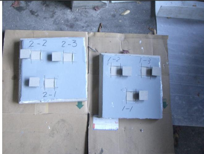
デリカウイング広島工場完成検査時の引張り検査
