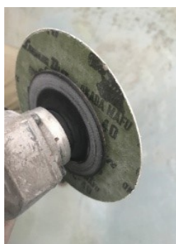
剥離部では銀色の素地ステンレスが見えております。
